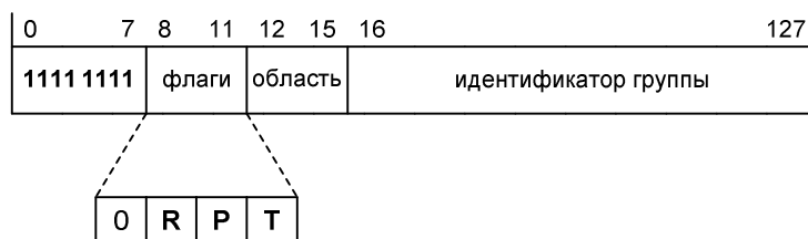
Фиг. 17. Формат группового адреса IPv6
