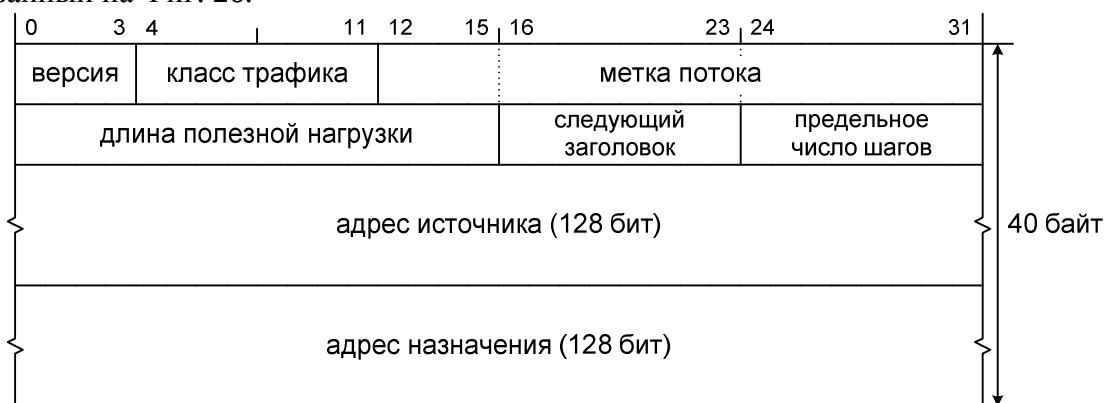
Фиг. 26. Основной заголовок IPv6
