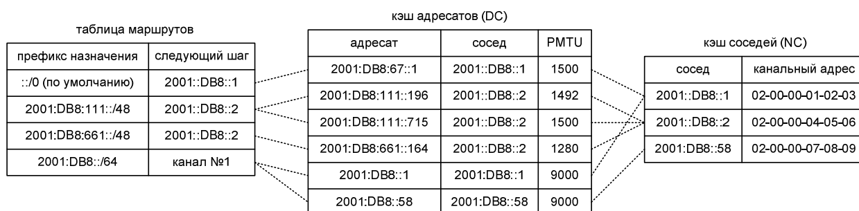
Фиг. 52. Связь между структурами данных в памяти узла: таблица маршрутов, DC и NC
