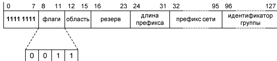
Фиг. 18. Формат адреса UBM
